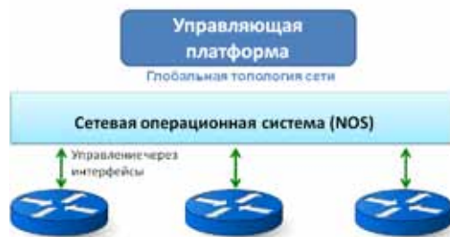
Рис. 2. Архитектура SDN версии 1 (SDN v.1)
