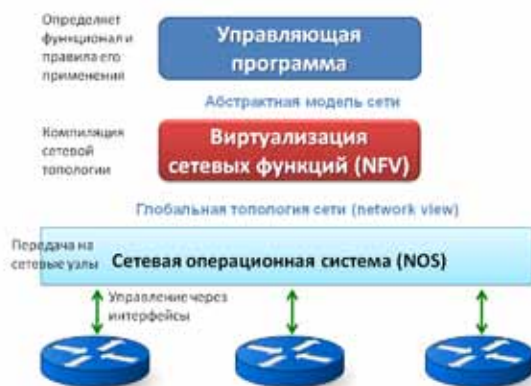
Рис. 4. Архитектура SDN версии 2 (SDN v.2)
